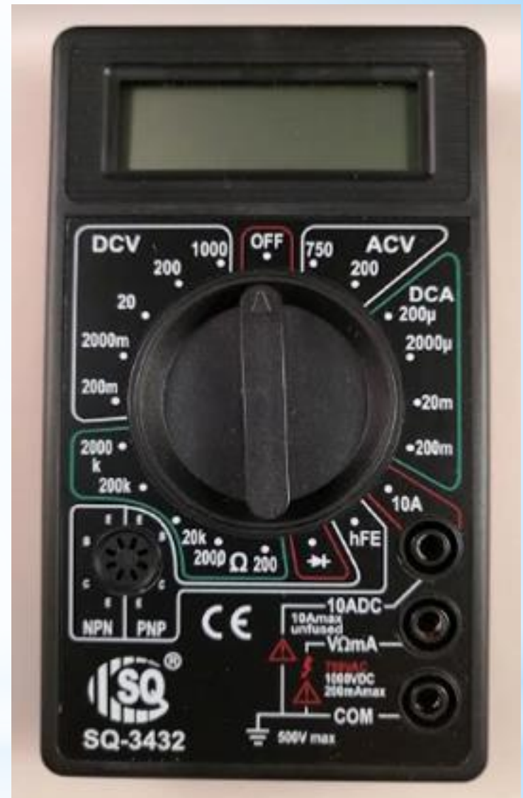
Foto do Multímetro com KNOB na parte central do equipamento que gira.
