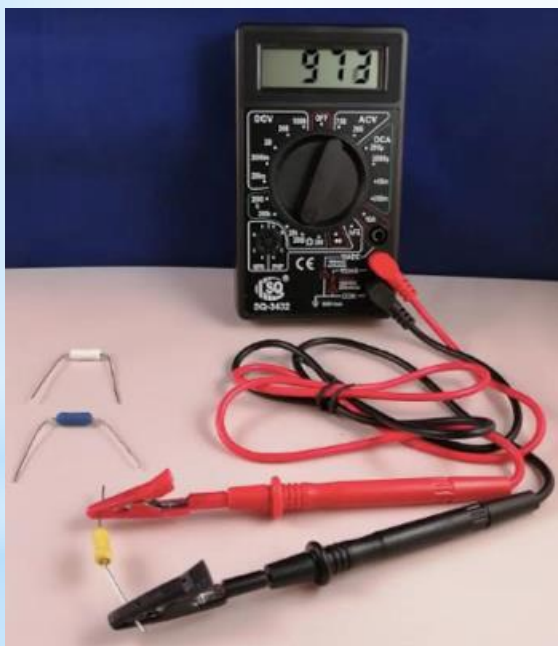
Medida da resistência elétrica do resistor AMARELO.
